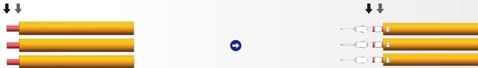
① 铆压端子的线安装到插座内，有咔哒声即为安装到位
