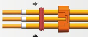
④ 放入屏蔽环外环.然后铆压(铆压尺寸8.5mm)
