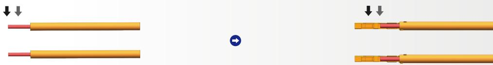
① 铆压互锁端子的线安装到插座内，有咔哒声即为安装到位
