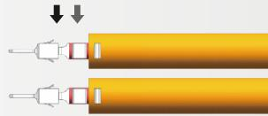
① 铆压端子的线安装到插座内, 有咔哒声即为安装到位
